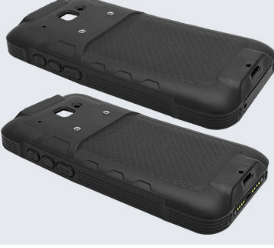
RB-C66-RR/RB-C66-RRP 保护胶套。 RB-C66-RR不支持充电底座； RB-C66-RRP底部有通讯顶针 RB-C66-P，支持座充 CRD-C66-RBC/CRD-C66-RBCE。
