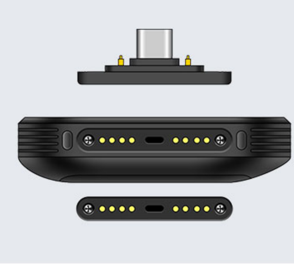
RB-C66-P Type C & Pogo Pin充电通讯顶针， 安装在保护胶套底部，使其可用座 充充电。当使用带网口底座 (CRD-C66-RBCE)充电时可使用有线 网络通讯。
