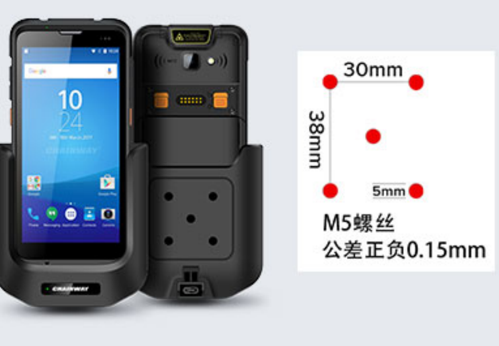
CRD-C66-VC 车载座充，与TypeC数据线配套使 用，需单独选购车载支架和车载适 配器
