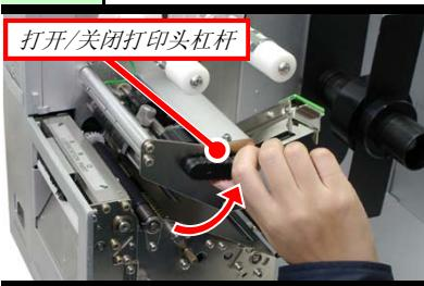
如图所示向右上方旋转，打开关闭打印头杠杆。
