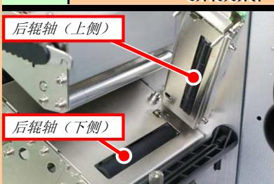
在新无尘布上洒上酒精，擦拭后辊轴的上侧和下侧。
