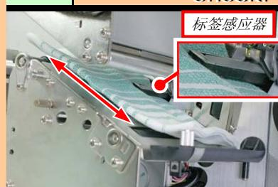
在新无尘布上洒上酒精，插入标签感应器的下方，上下移动着擦拭标签感应器。
