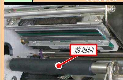
在新无尘布上洒上酒精，用手旋转着前辊轴擦拭前辊轴。
