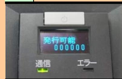
设置完成后，LCD屏幕会显示<発行可能>字样，如无，请重新装纸，再试一次。
