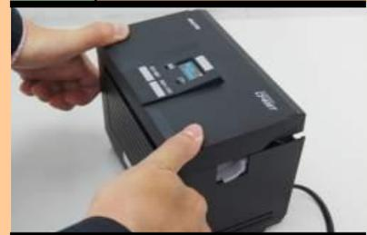
如图说示，双手按下打印机顶盖，听到咔嚓闭合声时即可。
