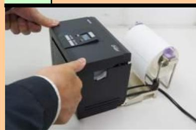
如图说示，双手按下打印机顶盖，听到咔嚓闭合声时即可。
