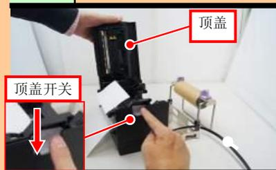
按下顶盖开关, 打开顶盖。如有余纸, 请取出。
