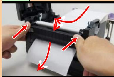
整理好底纸, 双手按住剥离器两端, 向上向内关闭剥离器。
