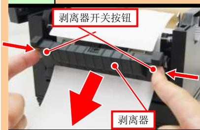
按住左右各一的剥离器开关按钮, 向内侧用力, 打开剥离器。如有标签尾纸请取出。
