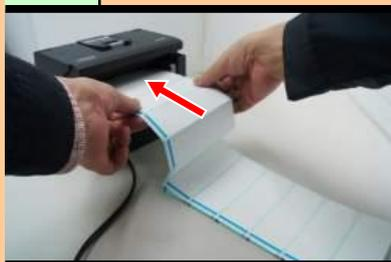
手持标签纸插入进纸口，自动进纸功能启动，走纸定位成功。
