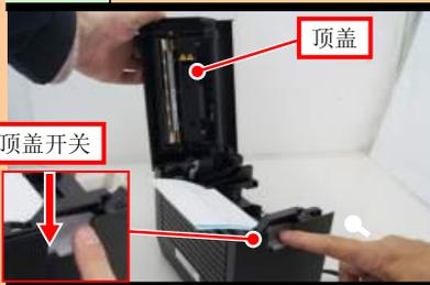
按下顶盖开关，打开顶盖。
