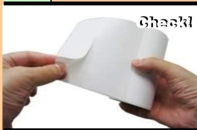
剥掉新标签纸的头10CM标签, 仅留底纸。如使用无底纸标签, 请忽视本步骤。
