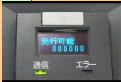
设置完成后，LCD屏幕会显示<発行可能>字样，如无，请重新装纸，再试一次。
